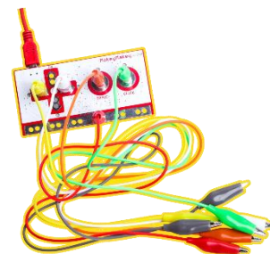
Fig. 2. dispositivo comercial Makey Makey®, en donde se puede observar que tiene para controlar clic, y movimientos de cursor o teclas de direccionamiento del teclado.
